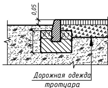
Схема понижения бортового камня при устройстве
