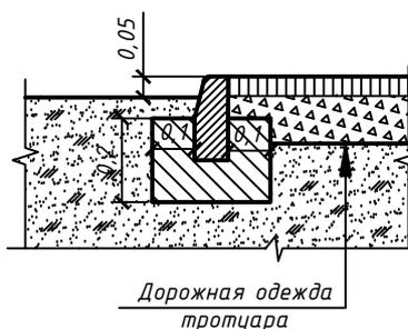
Схема понижения бортового камня при устройстве
